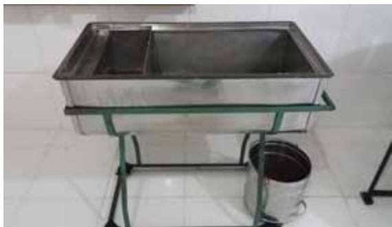
Figura 35. A mesa desoperculadora facilita o trabalho de desoperculação e não permite cair mel no chão, mantendo o ambiente limpo
