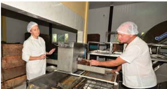
Figura 33. A máquina desoperculadora agiliza o trabalho na extração do mel
