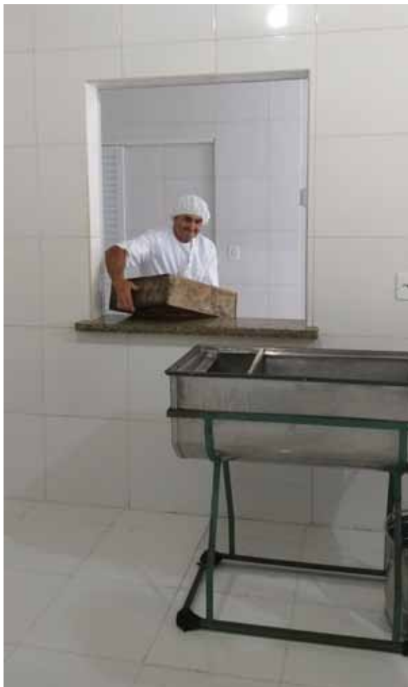
Figura 40. Quadros sendo transferidos através dos “óculos” evitando assim contaminações dentro da área de extração
