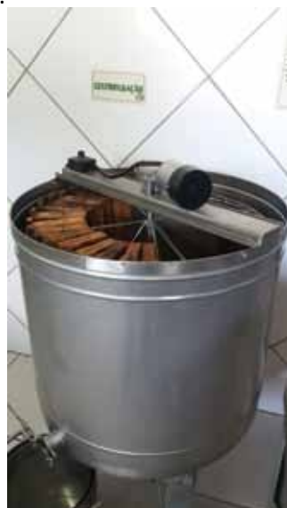
Figura 36. Para produções acima de 30 colmeias justifica-se a utilização de centrífuga elétrica pela diminuição de mão de obra
