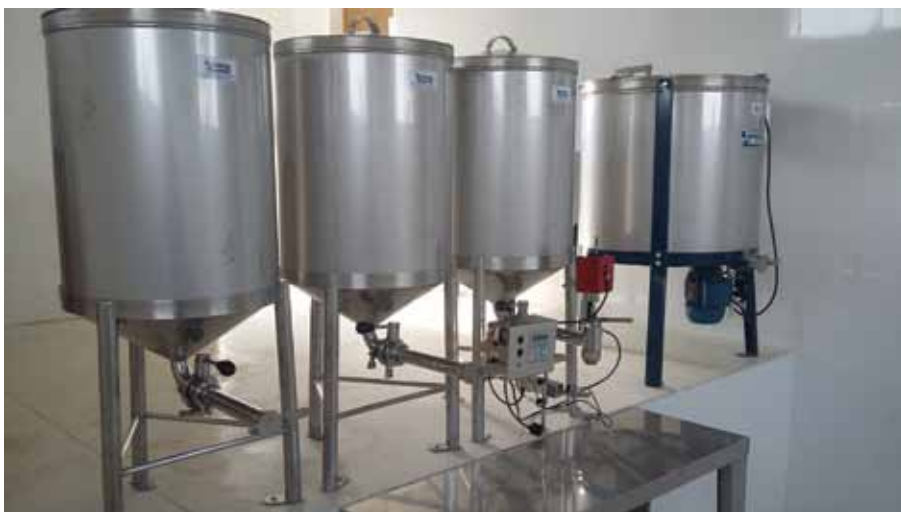
Figura 38. Tanque decantador com torneira para envase a granel Foto: Associação dos Apicultores de Capão Alto
