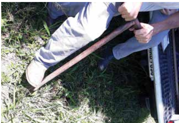
Figura 7. Sacho de ferro adaptado pela Epagri para plantio de mudas de pasto
