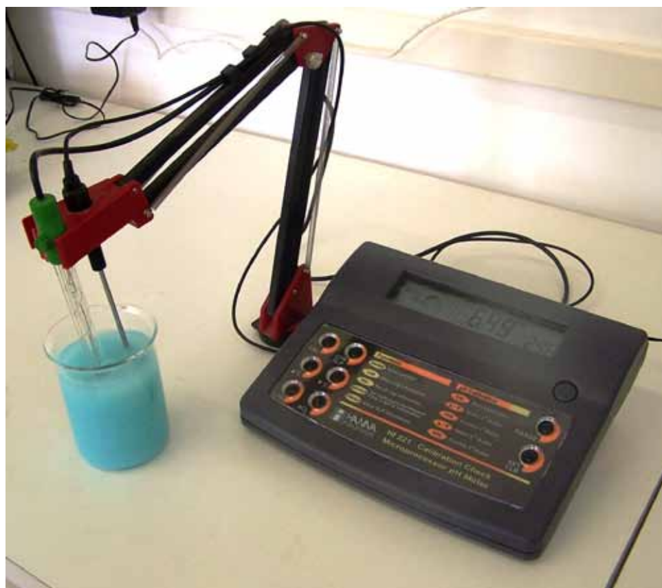
Figura 14. Medição de pH por meio de peagômetro
