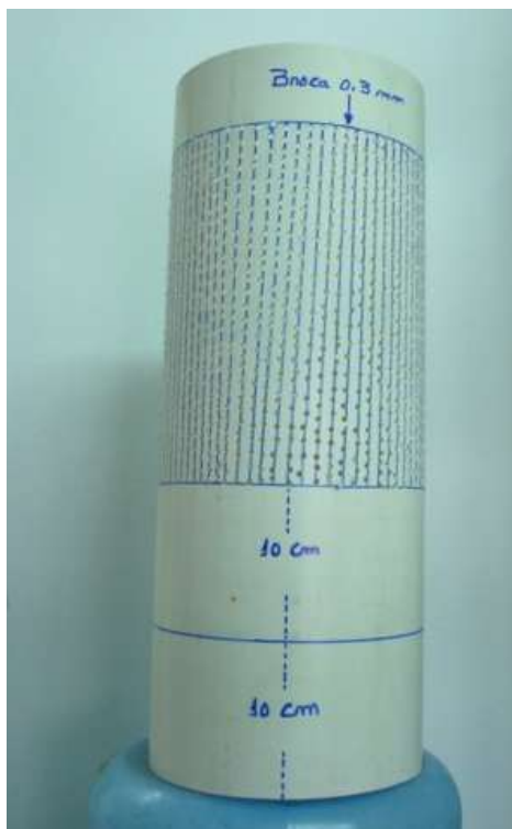
Figura 10. Perfurar o tubo de 200mm. De posse de um lápis e uma régua flexível, demarcar os pontos de perfuração, distanciados 1 centímetro quadrado um do outro. Perfurar com broca 3mm, inclusive o tampão ( cap ) posterior de 200mm.
