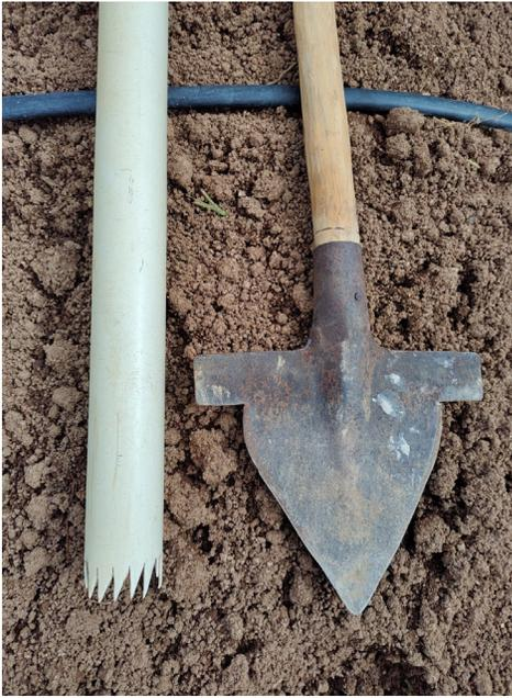
Figura 5. Instrumentos de perfuração do filme plástico (orifício e fenda longitudinal respectivamente) para abertura dos espaços de plantio (deposição) das manivas-semente
