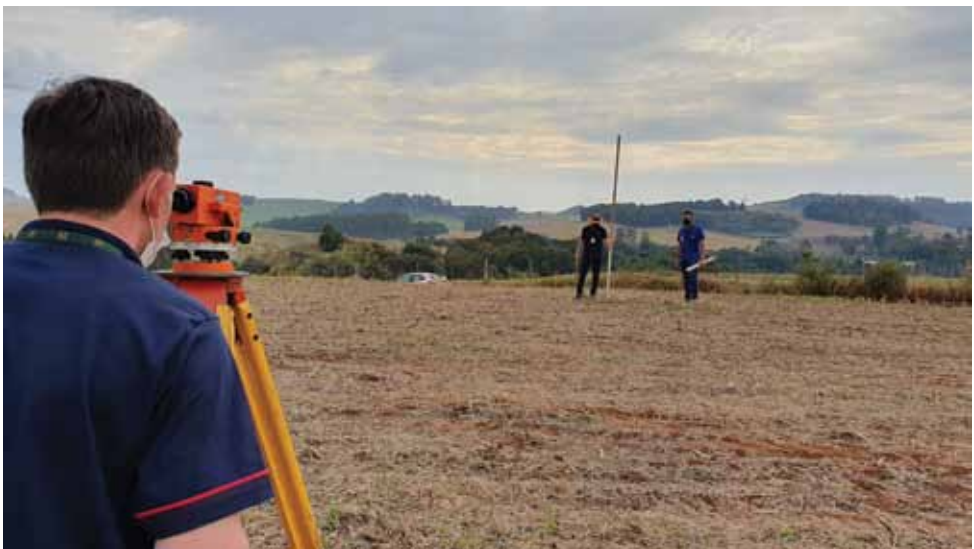
Figura 6. Determinação da declividade do terreno
