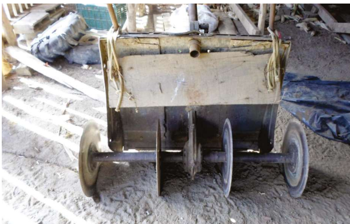
Figura 31- Implemento adaptado na rotativa e acionado na tomada de força do micro trator, composto por disco de corte, para manejar adubos verdes como a mucuna.
