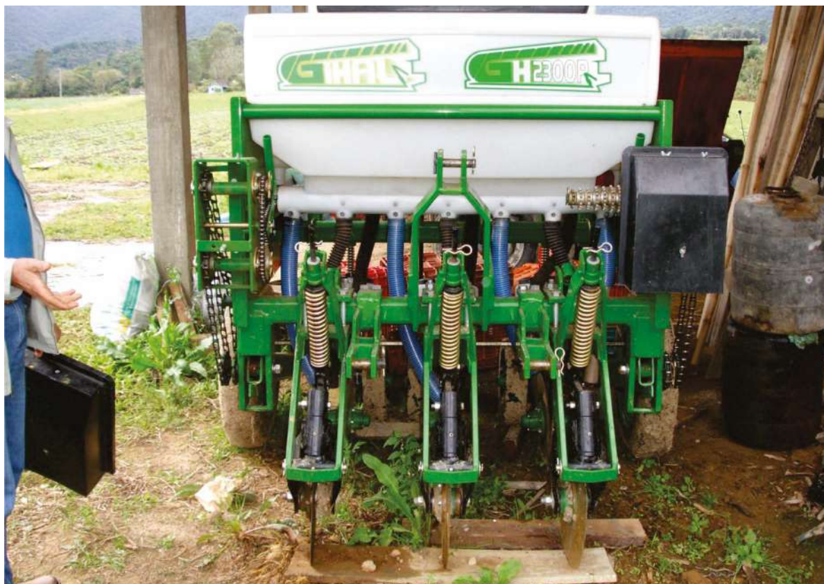
Figura 25- Implemento tracionado por trator para semeadura direta e preparo do berçário para o plantio de mudas, principalmente em canteiros, fabricado pela Gihal, Carazinho - RS.
