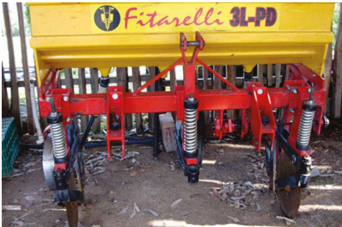
Figura 23- Implemento tracionado por trator, com disco de corte de 17" e facão com "dedo de ema", podendo trabalhar até com três linhas. Sua ampla regulação entre sulcos serve às brássicas, solanáceas e cucurbitáceas, fabricado com a Fitarelli.
