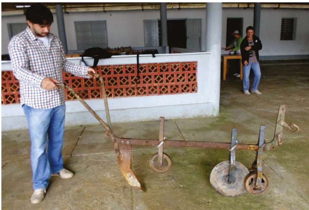
Figura 22- Implemento de tração animal, para agricultura de montanha, composto por duas rodas guias, disco de corte e sulcador, desenvolvido com lavoureiros de mandioquinha salsa da comunidade de Rio Fortuna, Angelina-SC.
