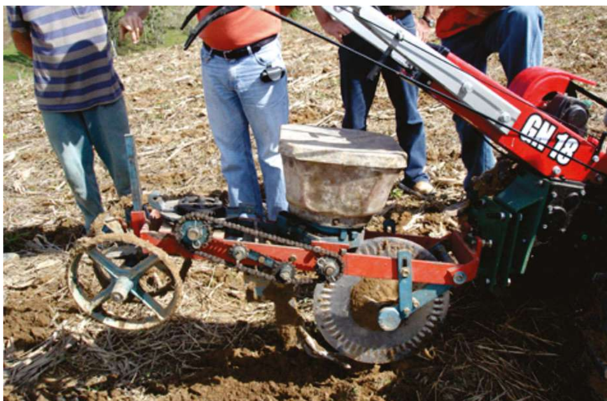
Figura 24- Implemento tracionado por micro-trator, equipado com disco de corte corrugado, facão e distribuidor de semente e fertilizante, fabricado pela Marcassio.
