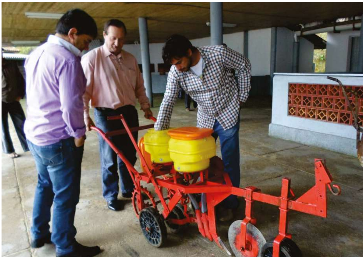
Figura 21- Implemento de tração animal, adaptavel ao trator, sulcador, disco 16" e duas rodas guias para regular profundidade e trabalhar com o disco o corte da vegetação.
