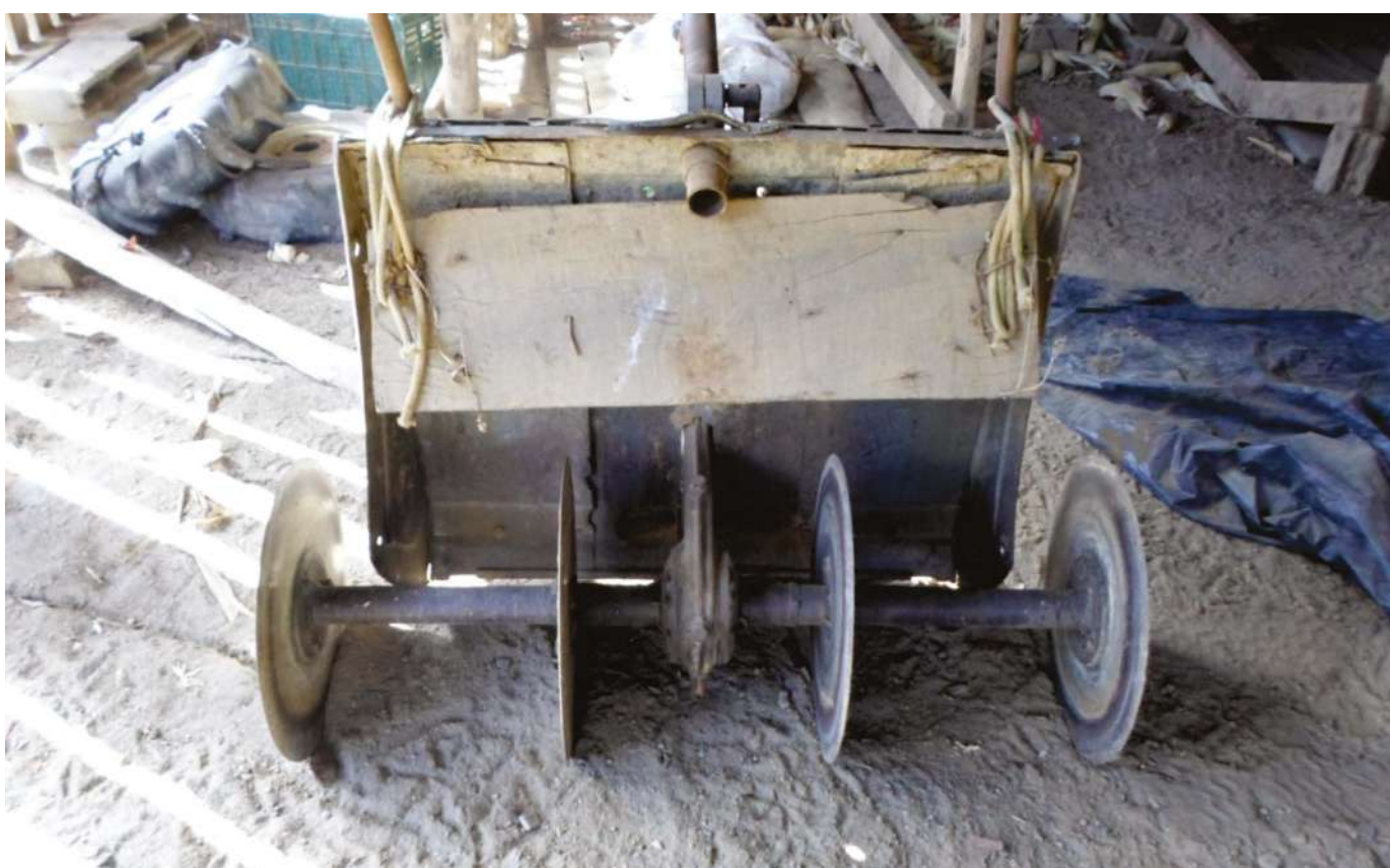
Figura 25 - Implemento adaptado na rotativa e acionado na tomada de força do micro trator, composto por disco de corte para manejar adubos verdes, como a mucuna.
