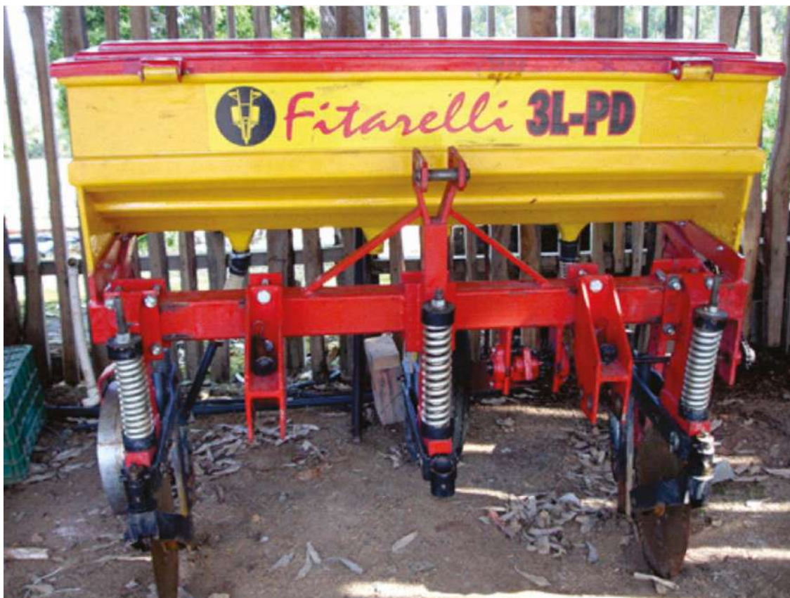
Figura 26 - Implemento a tração tratorizada, com disco de corte de 17", facão com "dedo de ema" e distribuição do fertilizante, fabricado pela Fitarelli.
