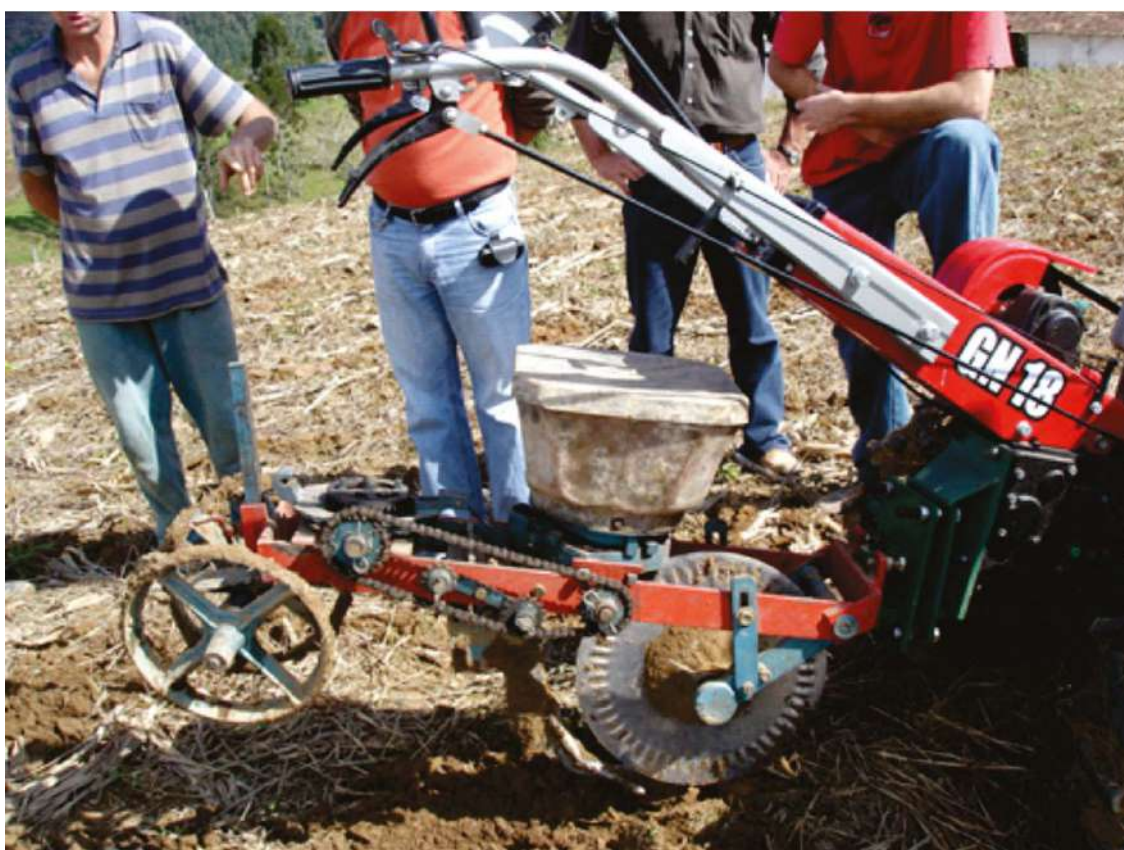
Figura 27 - Implemento tracionado por microtrator, equipado com disco de corte corrugado, facão e distribuidor de semente e fertilizante.
