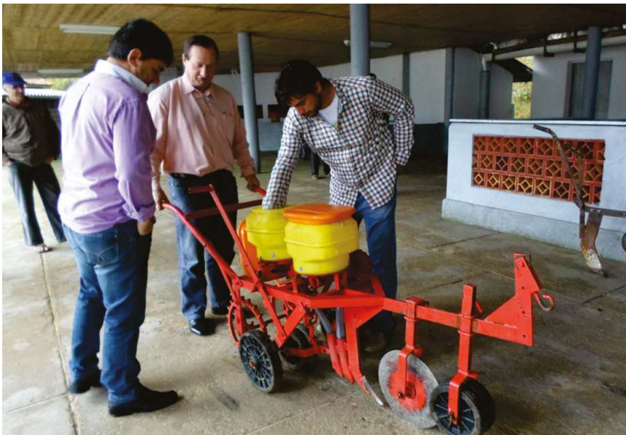
Figura 22 - Implemento a tração animal, que pode ser adaptado ao trator com roda guia de profundidade, disco de corte e sulcador, com distribuidor de adubo e semente.
