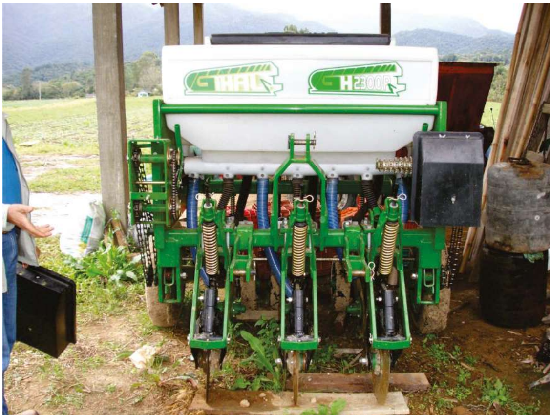
Figura 28 – Implemento tracionado por trator para semeadura direta e preparo do berçário para plantio de mudas, principalmente em canteiros, fabricado pela empresa GIHAL – Carazinho RS.
