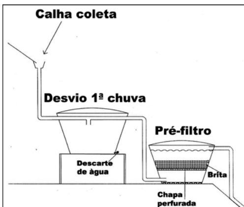
Figura 12. Detalhe esquemático do sistema de pré-filtragem
