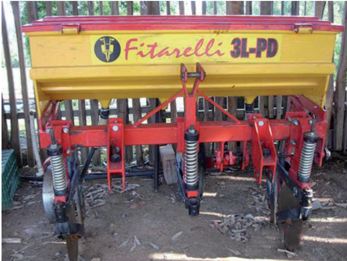
Figura 24. Máquina para preparo do berço em sulco com tração tratorizada
