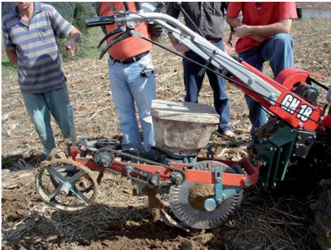
Figura 25. Máquina para preparo do berço em sulco com tração microtratorizada
