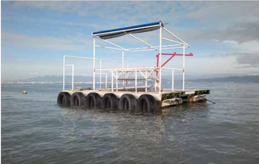
Figura 10. Balsa com pneus utilizados como defensas, o que não é permitido pelo órgão ambiental
