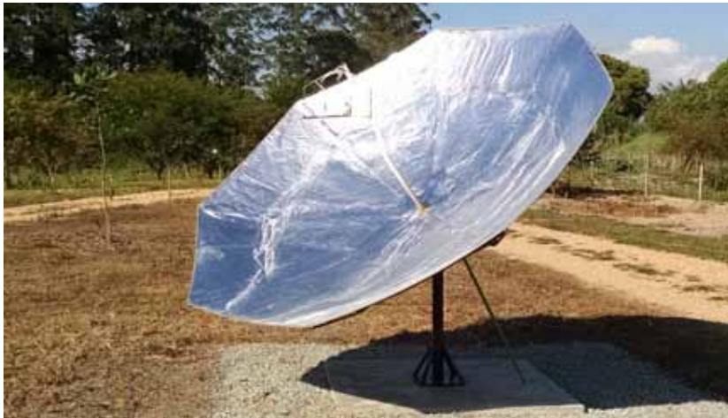
Figura 32. Fogão solar feito de antena parabólica
