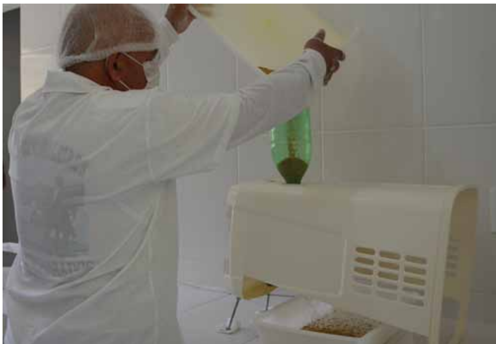
Ventilação para a retirada de impurezas leves
