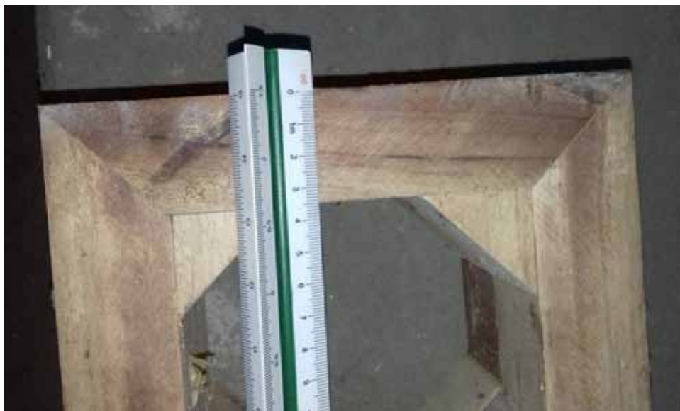
Figura 21. Espessura mínima da parede da caixa
