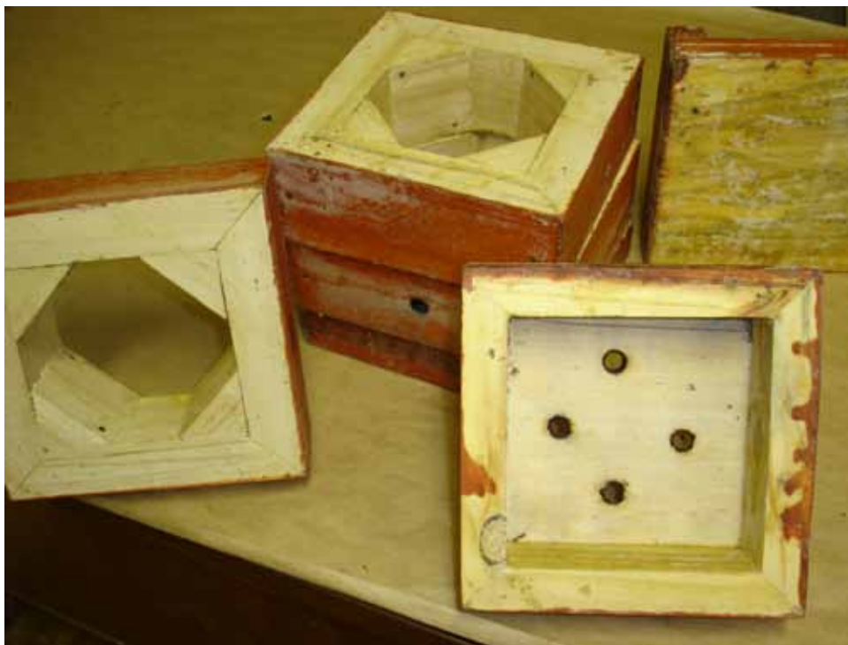
Figura 22. Partes de uma caixa (modelo vertical)
