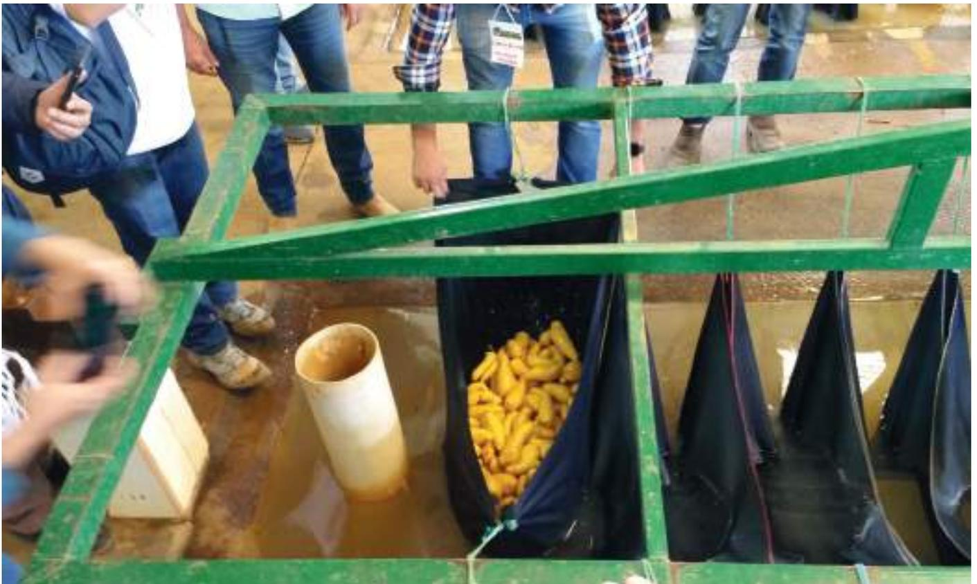
**Figura 32.** Lavador pendular com panos pendurados em um quadro movido por força motriz excêntrica, acionado por motor elétrico em Senador Amaral (MG), 2018.
