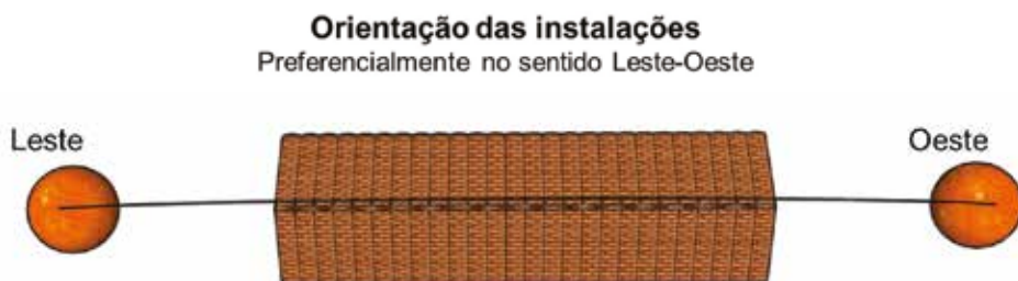
Figura 2. Detalhe da orientação recomendada para instalações – Linha da cumeeira no sentido leste-oeste
