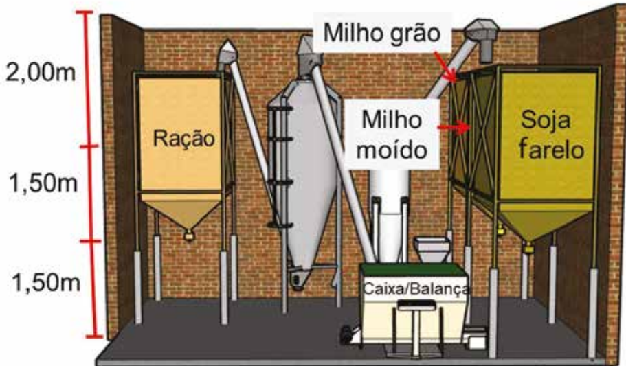
Figura 43. Vista lateral da fábrica de ração com fluxograma utilizado para confecção e armazenamento da ração
