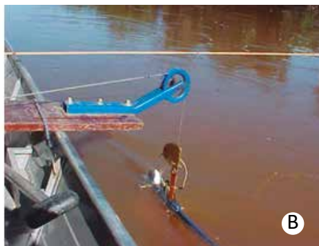
Figura 8. Medição de vazão com barco preso a um cabo (A) e molinete com guincho (B) Fonte: Do autor (2025)
