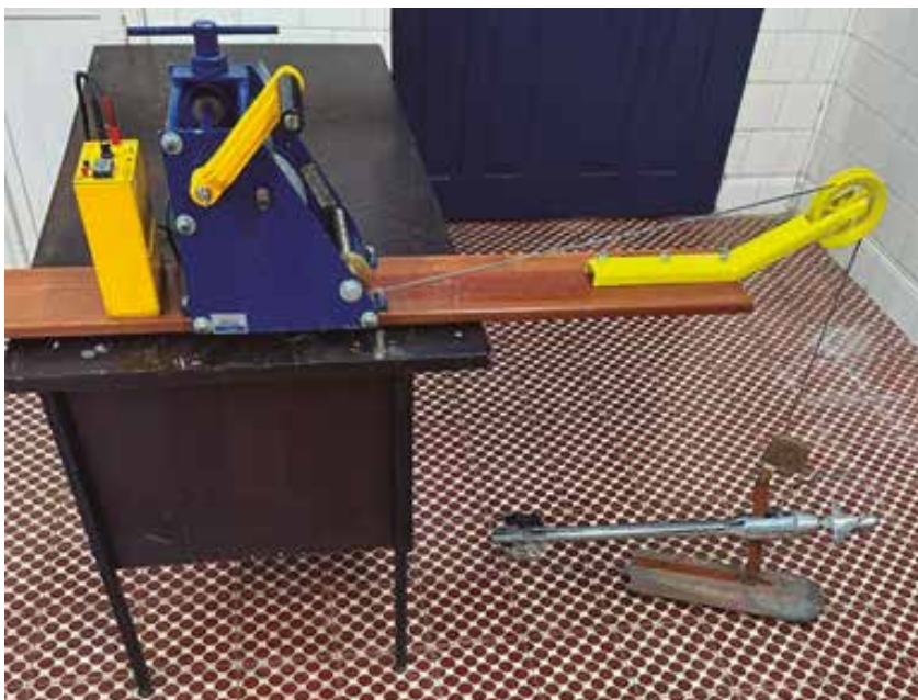
Figura 9. Guincho hidrométrico e molinete com lastro de 15kg
