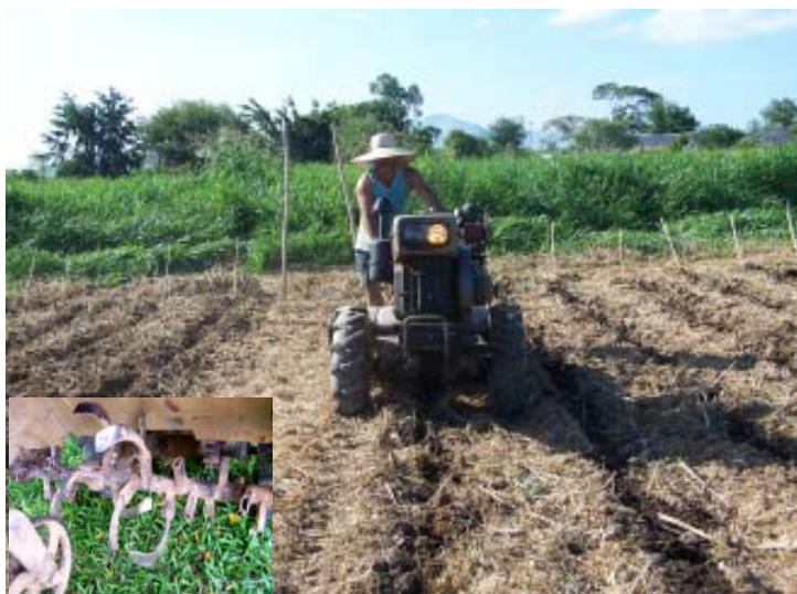
Figura 21. Abertura de sulcos para plantio de pepineiros com as enxadas centrais da rotativa (no detalhe) de microtrator. A área entre filas permanece intacta e coberta pela palhada da vegetação de cobertura, que foi roçada
