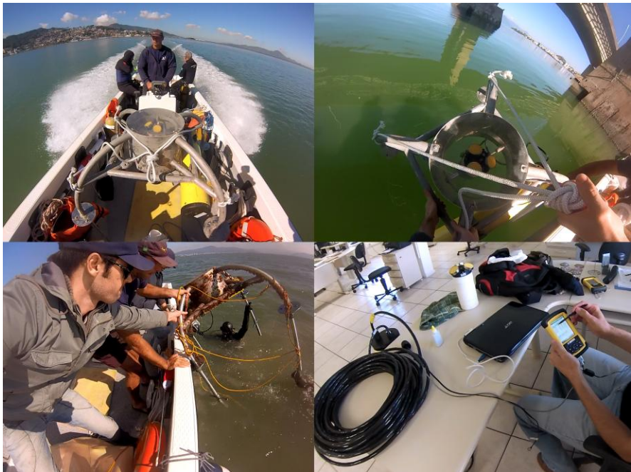
Figura 7. Instalação, retirada e coleta dos dados do equipamento ADCP
