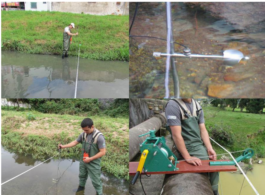
Figura 4. Medição da descarga líquida de rios utilizando diferentes modelos de molinete hidrométrico
