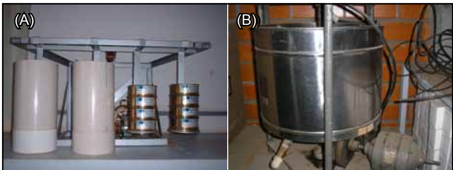
Figura 7. Equipamento utilizado para determinar a estabilidade de agregados em água em amostras individualizadas (7A) e aparelho de Yoder (7B)
