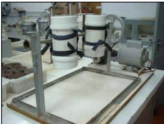
Figura 8. Equipamento rotativo, utilizado para aplicar energia de desagregação adicional aos agregados antes do peneiramento em água para determinação de sua estabilidade
