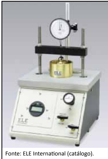
Figura 5. Consolidômetro, equipamento utilizado para realizar o ensaio de compressibilidade em amostras de solo
