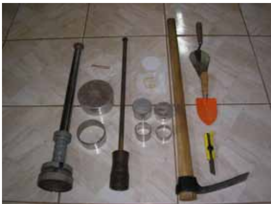
Figura 11. Materiais e equipamentos utilizados para coleta de amostras de solo com estrutura preservada
