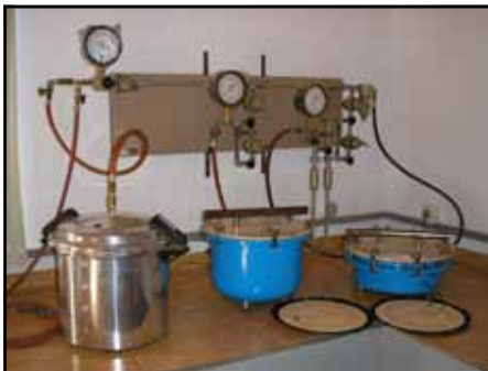
Figura 2. Extrator de Richards, equipamento utilizado para determinação da retenção de água em amostras de solo em médias e altas tensões (10 a 1.500kPa)
