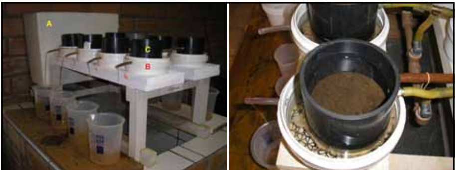
Figura 6. Permeâmetro de carga constante, equipamento utilizado para determinar a condutividade hidráulica saturada em amostras de solo. A: sistema para fornecimento de água com lâmina constante; B: recipiente para acondicionamento da amostra de solo imersa em água; e C: dispositivo para aplicação de lâmina de água acima da amostra
