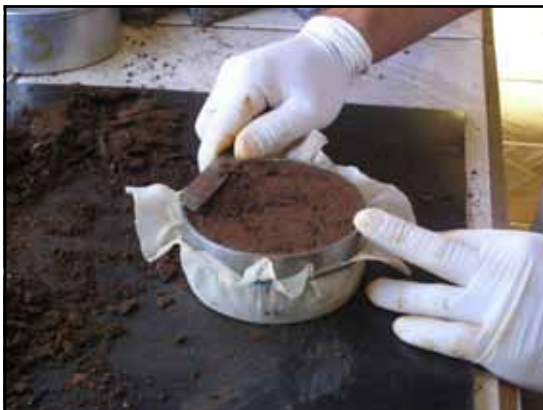
Figura 13. Preparo das amostras coletadas com estrutura preservada para a realização das análises
