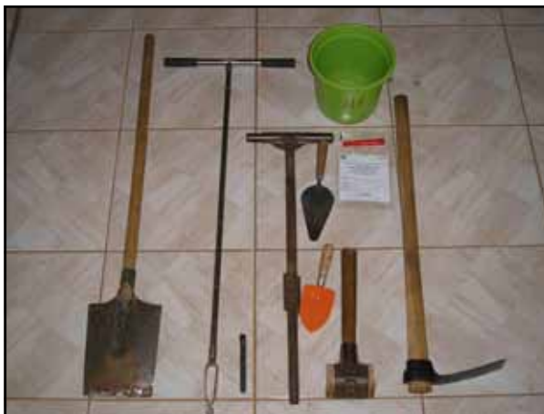
Figura 14. Materiais e equipamentos utilizados para coleta de amostras com estrutura alterada
