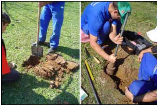
Figura 12. Procedimento de coleta de amostras de solo com estrutura preservada.
