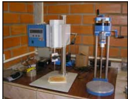
Figura 3. Penetrômetro de bancada e vane tester , equipamentos utilizados respectivamente para determinar a resistência à penetração e ao cisalhamento do solo
