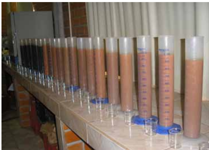
Figura 10. Conjunto de amostras para determinação da granulometria por um operador, em rotina de laboratório
