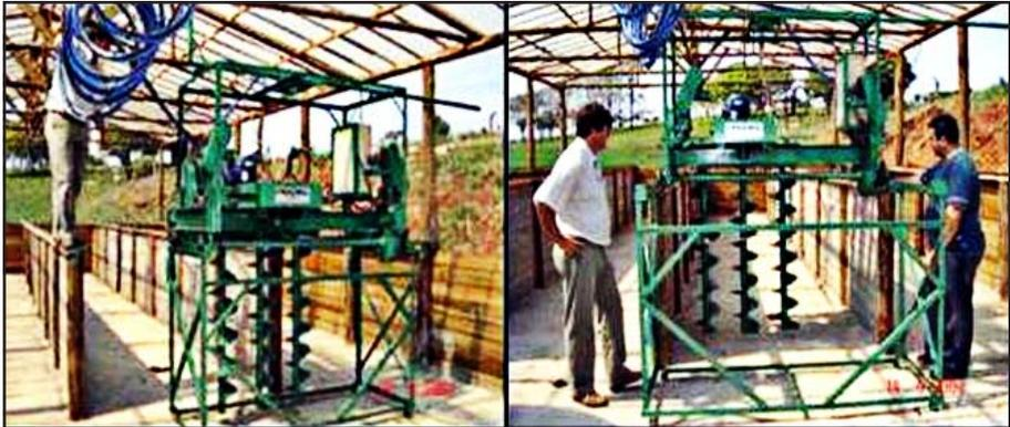
Figura 1. Vista parcial da unidade de compostagem instalada no Cetrédia, contendo um revolvedor automático dotado de três roscas sem-fim
