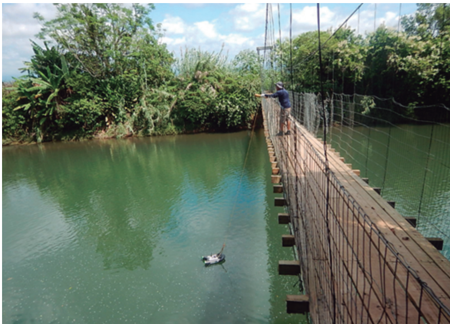
Figura 7. Medição de vazão a partir de pontes Fonte: Foto de Renan Boaroli (2025)
