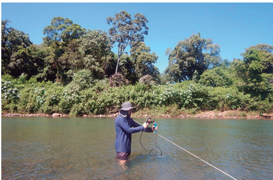
Figura 6. Medição a vau
