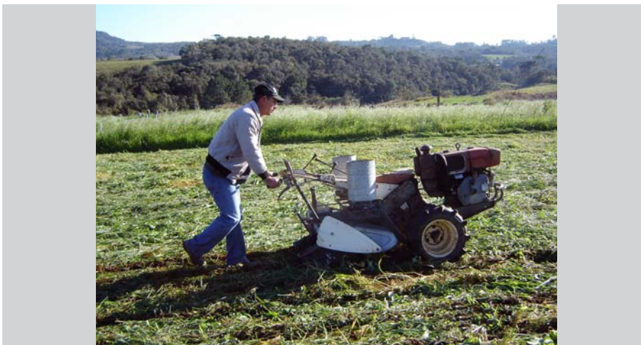
Figura 5. Abertura do sulco sobre palha de aveia e nabo forrageiro com implemento adaptado
