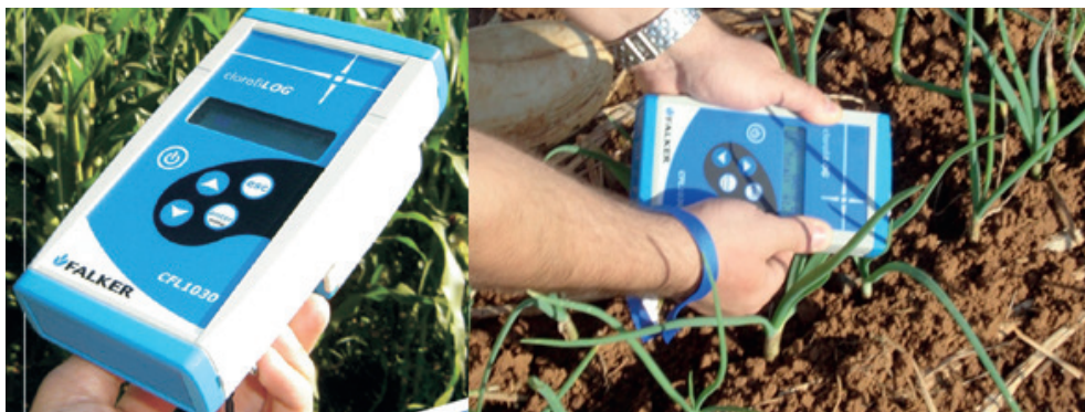
Figura 15. Clorofilômetro portátil utilizado nas avaliações na Estação Experimental de Ituporanga, Modelo CFL 1030 ClorofiLOG da marca Falker
