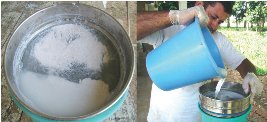
Figura 4. Coagem do “leite” da cal e detalhe dos resíduos
