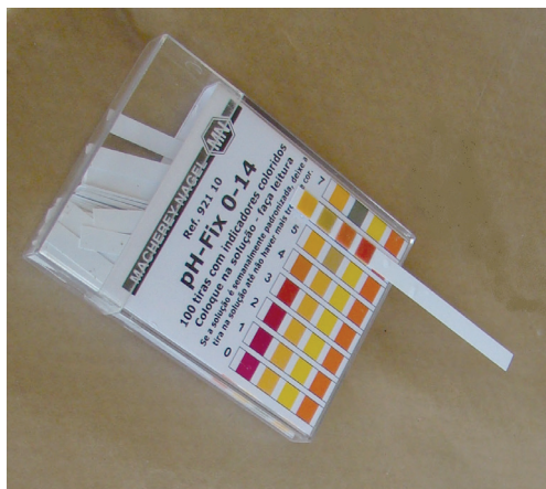
Figuras 11B. Leitura do pH da calda bordalesa por meio de tiras de papel tornassol ou por peagâmetro
