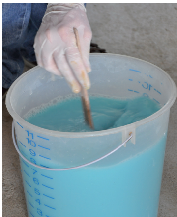
Figura 11A. Agitação da calda para medição do pH por meio de peagâmetro ou por fitas coloridas de papel tornassol
