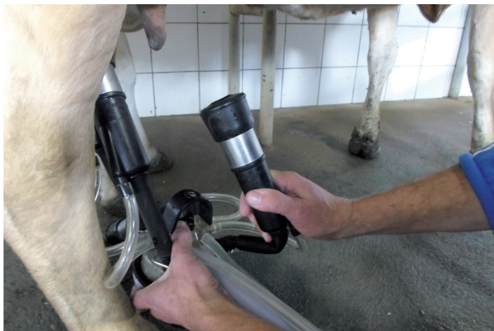
Figura 21. Colocação das teteiras em “Z”, evitando flutuações no vácuo do sistema de ordenha
