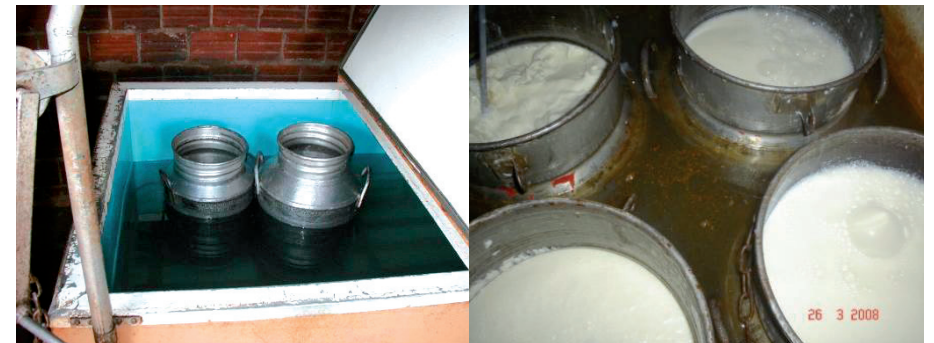
Figura 27. Tanque de imersão (A) com pouca água e (B) com água suja
