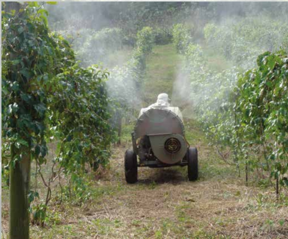
Figura 5 – Pulverização com turbina para controle de doenças em pomar de maracujazeiro
