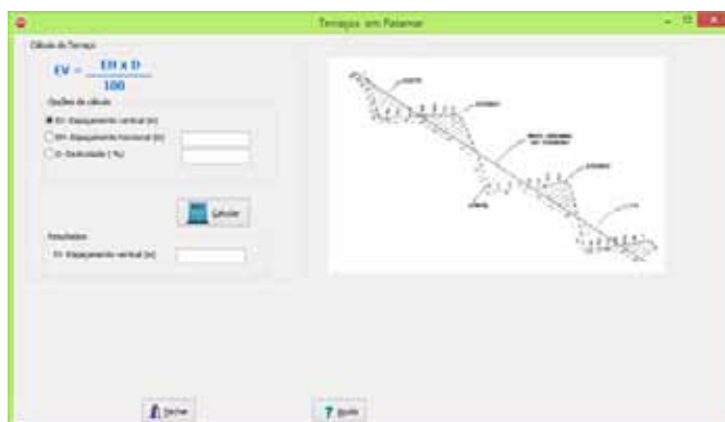
Figura 73. Tela da rotina de cálculo do espaçamento vertical para locação de terraço tipo patamar no HidroTerraço
