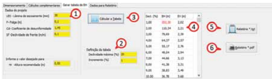
Figura 64. Aba Gerar tabela de espaçamento Horizontal (EH) da rotina de cálculo para dimensionamento de terraço em nível pelo método de Pruski et al. (1997)
