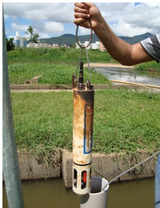
Figura 20 - Captação de água para abastecimento urbano – rio Camboriú ( a ) e detalhe da sonda multiparamétrica ( b )
