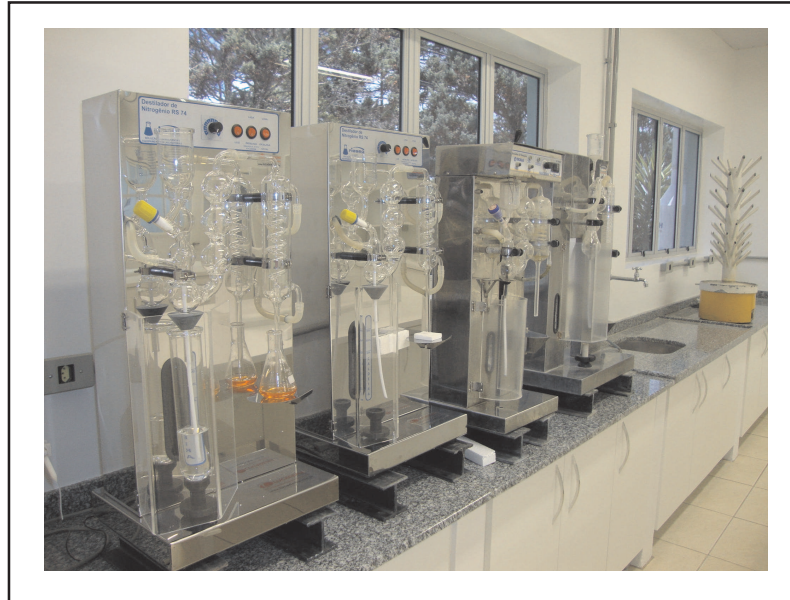
Figura 5. Destiladores semimicro Kjeldal, utilizados para determinar a quantidade de N no extrato, em diferentes fases do processo analítico. A: tubo de digestão contendo o extrato digerido; B: Erlemeyer para recepção do destilado
