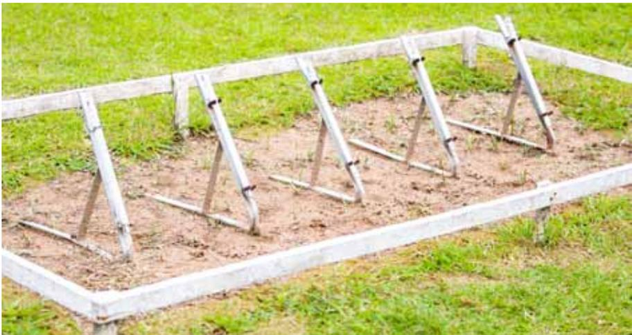
Figura 19. Geotermômetros protegidos por estrutura metálica para evitar danos físicos.
