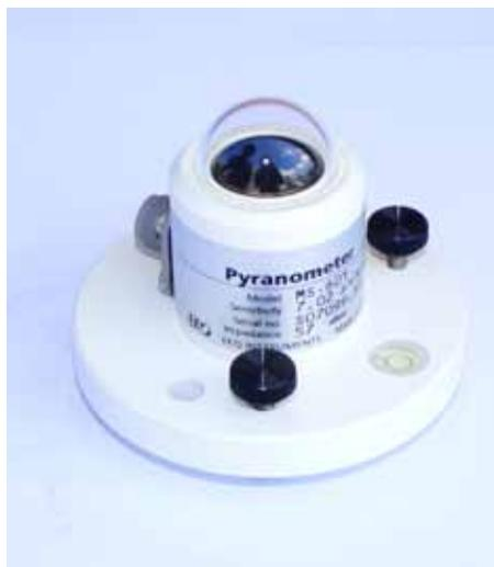
Figura 6. Piranômetro utilizado na rede de estações meteorológicas da Epagri.
