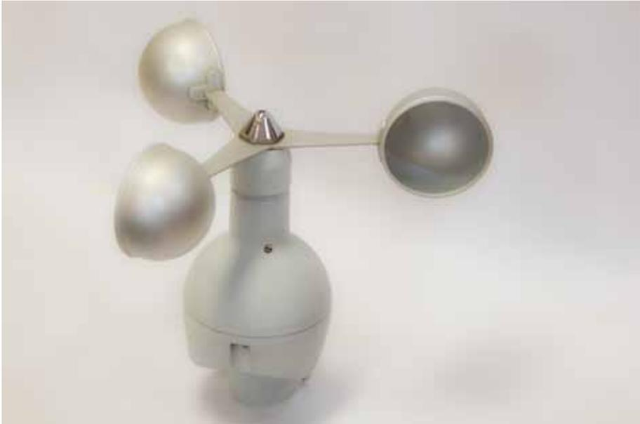
Figura 22. Anemômetro totalizador.
