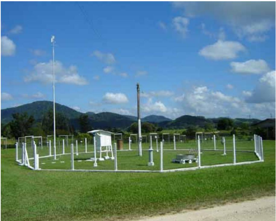
Figura 2. Modelo octogonal de estação meteorológica adotado pela Epagri/Ciram na Estação Experimental de Itajaí, SC.
