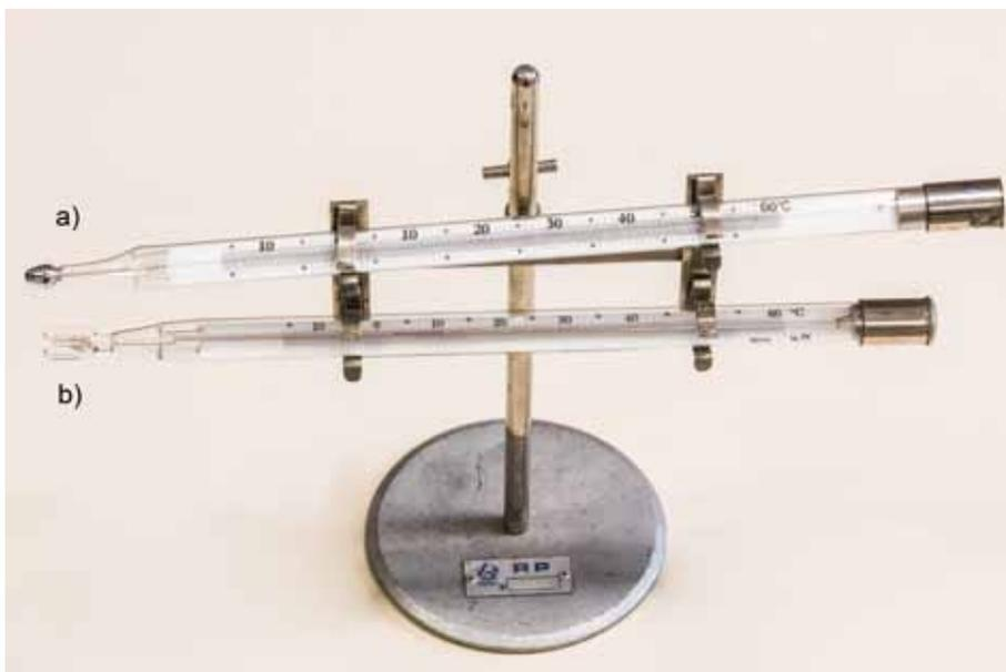
Figura 8. Termômetro de máxima na parte superior do suporte (a) e termômetro de mínima na parte inferior (b).
