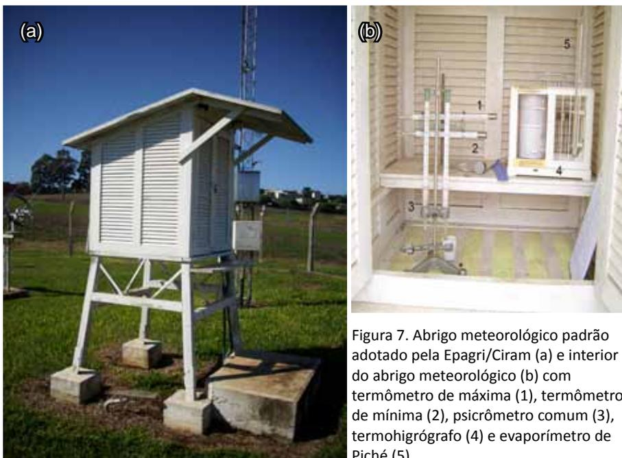
Figura 7. Abrigo meteorológico padrão adotado pela Epagri/Ciram (a) e interior do abrigo meteorológico (b) com termômetro de máxima (1), termômetro de mínima (2), psicrômetro comum (3), termohigrógrafo (4) e evaporímetro de Piché (5).
