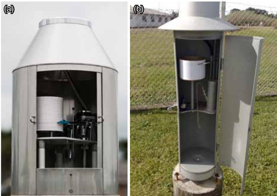
Figura 12. Pluviógrafo modelo Hidrologia (a) e Hellmann Fuess(b).
