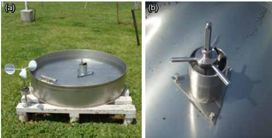
Figura 14. Tanque de evaporação “classe A” (a) e parafuso micrométrico (b) usados para leituras.
