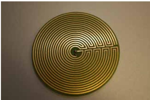
Figura 18. Placa ou circuito para detecção do molhamento folhar (orvalho), Epagri.
