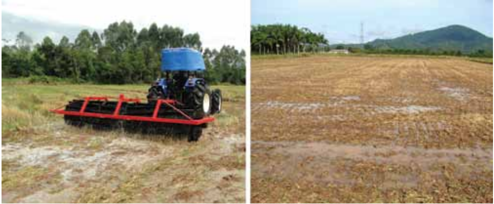
Figura 8. Rolo-faca acoplado ao trator para a incorporação da palha do arroz (esquerda) e aspecto da área trabalhada (direita)
