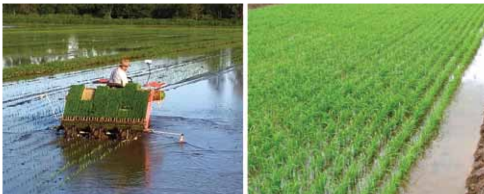
Figura 4. Transplantadeira de mudas de arroz em operação e aspecto da lavoura implantada
