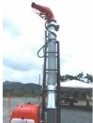
Pulverizador atomizador – detalhe do tubo de condução do ar e dos bicos de pulverização
