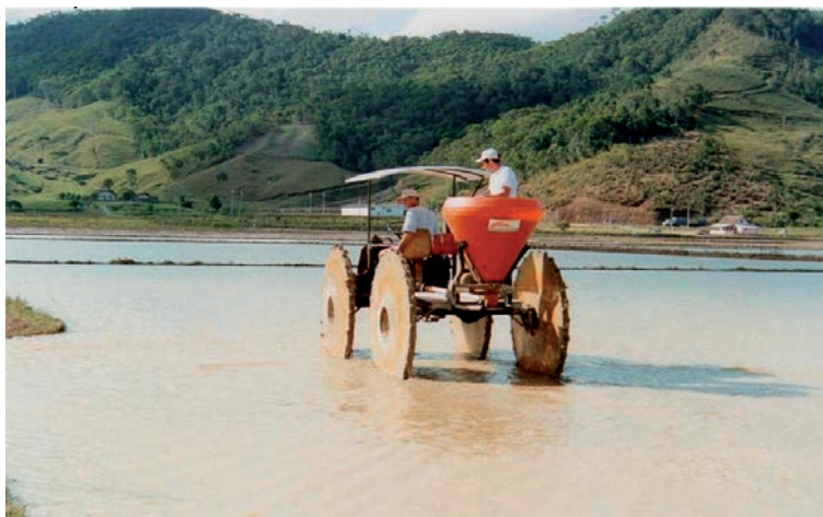
Figura 13. Trator com rodas de ferro semeando a lanço sementes pré-germinadas
