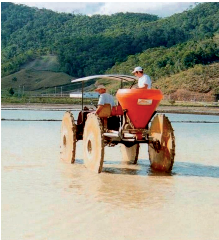
Figura 1: Trator com rodas de ferro semeando a lanço sementes pré-germinadas.
