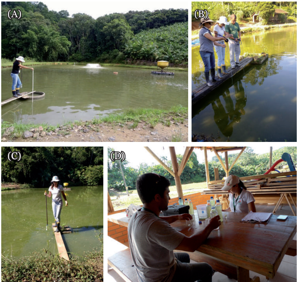
Figura 21. Acompanhamento da análise de água a campo. (A) Leitura da transparência com o disco de secchi; (B) Leitura do oxigênio e temperatura com oxímetro; (C) Coleta de água do viveiro a um metro de profundidade com garrafa de coleta artesanal; (D) Análises de pH, alcalinidade, amônia e nitrito
