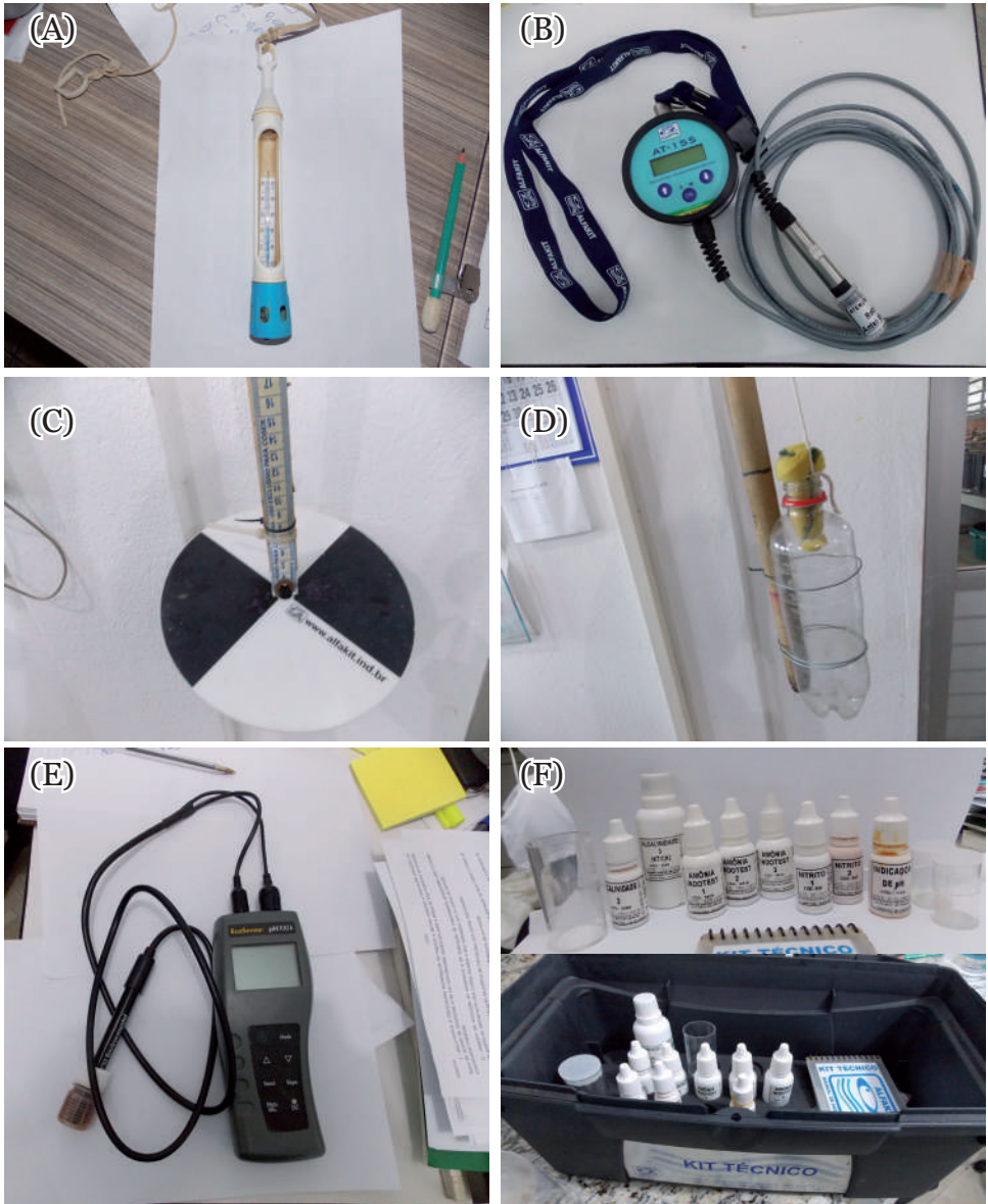
Figura 22. Equipamentos utilizados na medição dos parâmetros de qualidade de água. (A) Termômetro; (B) Oxímetro digital; (C) Disco de Secchi; (D) Garrafa de coletora de água para amostragem na coluna da água; (E) pHmetro digital; (F) Kit de análise de água Fotos: Haluko Massago
