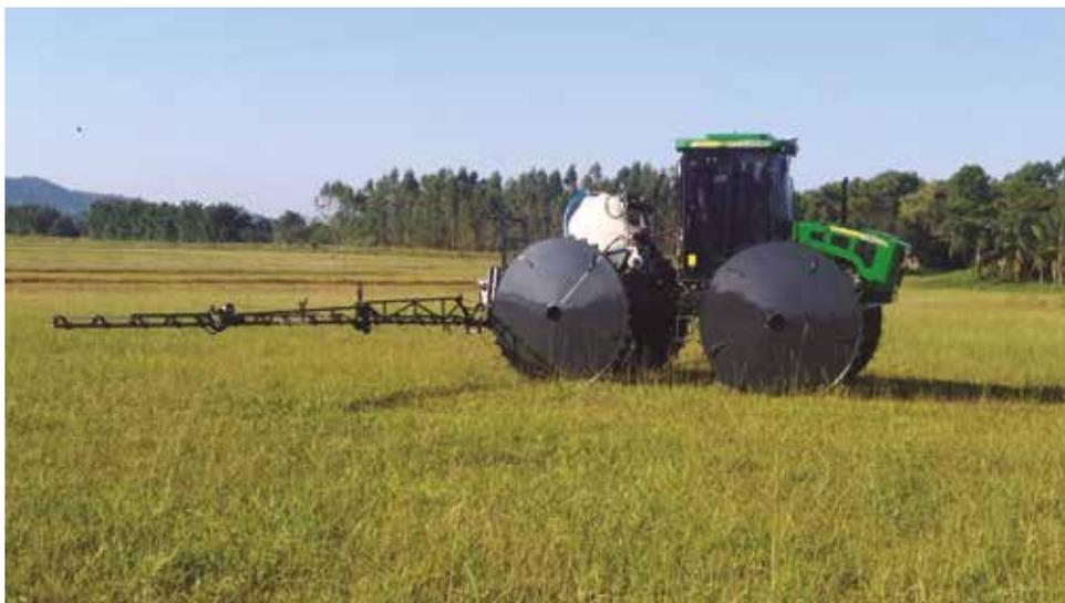
Figura 18. Trator SAP cabinado com GPS e controle de vazão por sessão da barra de pulverização, produzido em Jaraguá do Sul, SC, pela Cattoni Máquinas e Implementos, adquirido pela Epagri/Estação Experimental de Itajaí, através de recursos da Finep – Itajaí, 2020
