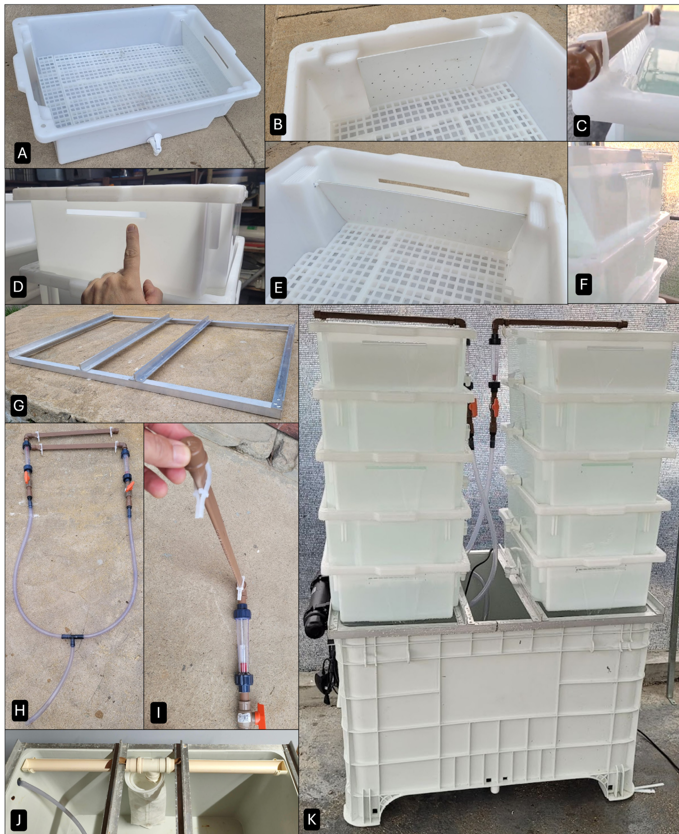
Figura 1 - Detalhes construtivos da depuradora vertical modelo Epagri. A - Caixas de pescado adaptadas; B - Compartimento de entrada de água; C - Água entrando na caixa pela entrada de água; D - Abertura de drenagem de água; E - Compartimento de saída de água; F - Água saindo da caixa pela abertura de drenagem; G - Estrutura para apoio das caixas; H - Conjunto de entrada de água; I - Detalhe da barra de entrada de água; J - Calha de drenagem e filtro mecânico tipo “bag”; K - Depuradora montada
