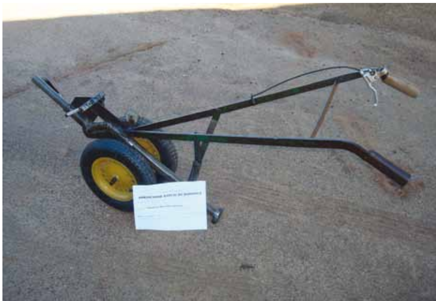
Figura 2. Protótipo do arrancador manual de mandioca
