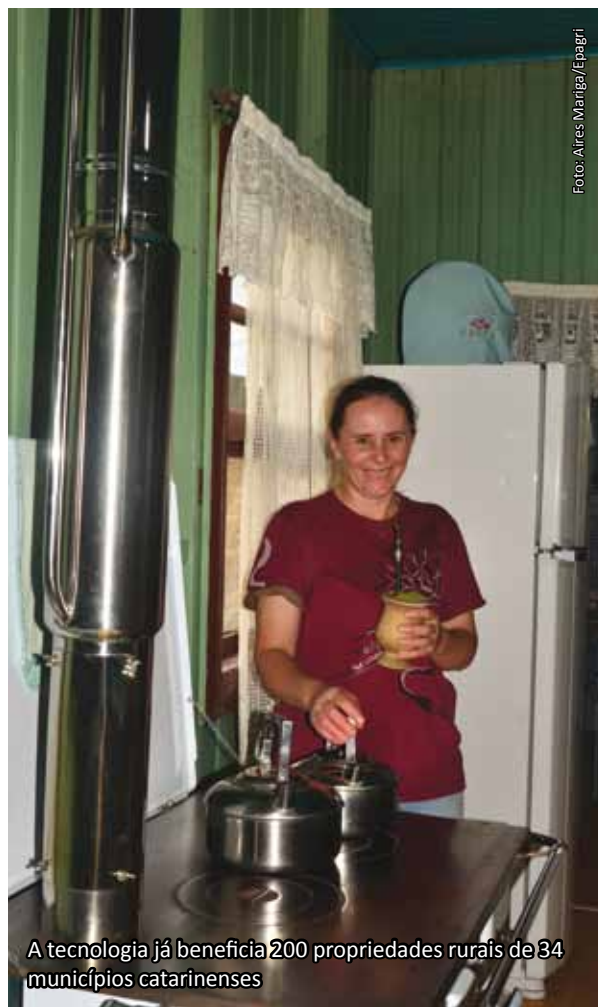
A água entra no trocador, esquenta e retorna para o boiler, que mantém a temperatura
