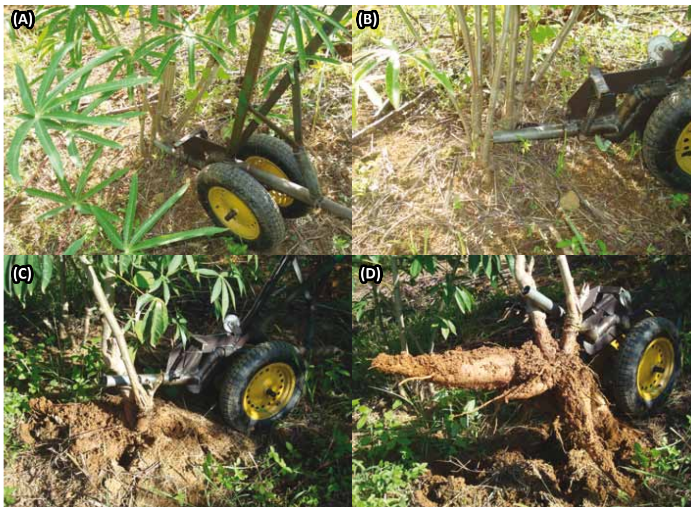
Figura 4. Etapas na colheita de raízes de aipim de dois ciclos realizada com o protótipo de arrancador manual desenvolvido na Epagri/ Estação Experimental de Urussanga: A) prendendo o equipamento à rama; B) equipamento preso à rama; C) arrancando as raízes do solo; D) raízes arrancadas do solo
