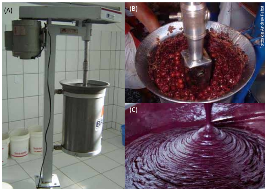
Figura 1. Detalhes das etapas do processamento: a) despulpadora; b) frutos sendo despulpados no interior do cilindro; c) açaí extraído.
