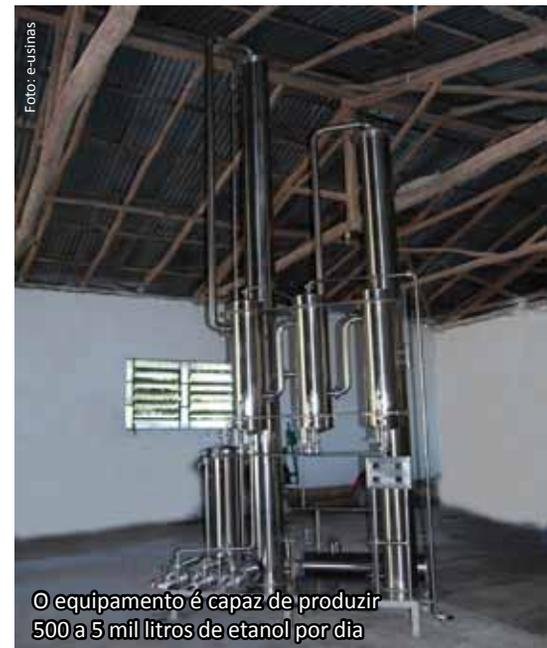
O equipamento é capaz de produzir 500 a 5 mil litros de etanol por dia
