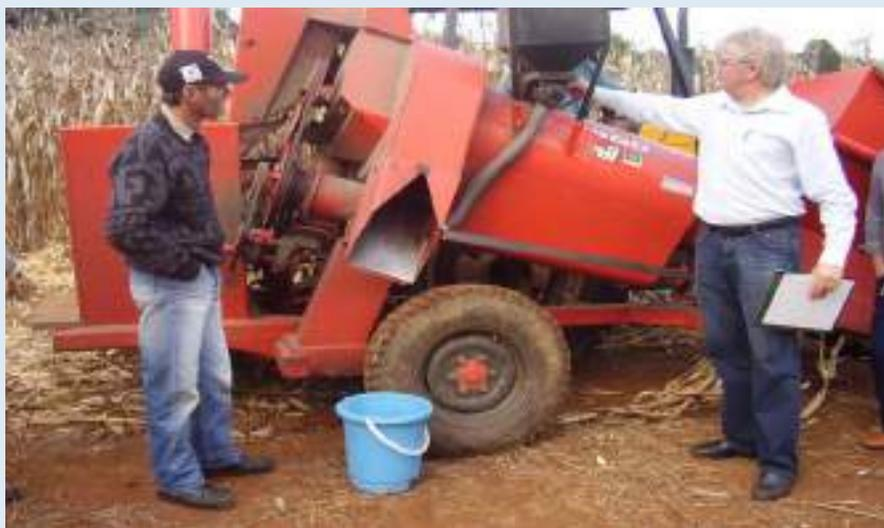
*Deslocando as canaletas do rotor é possível variar a vazão de sementes entre 30 e 150kg/ha*
