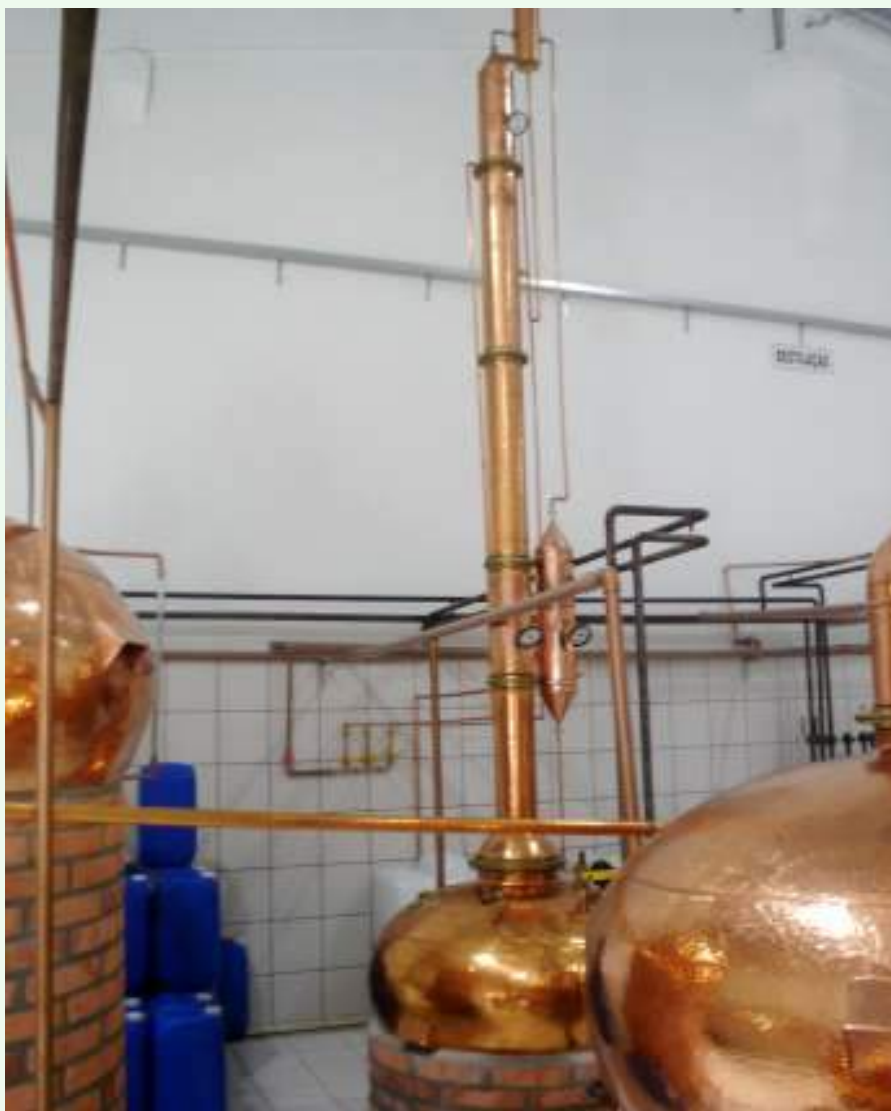
Figura 3. Microdestilaria com coluna para destilação de álcool construída em cobre
