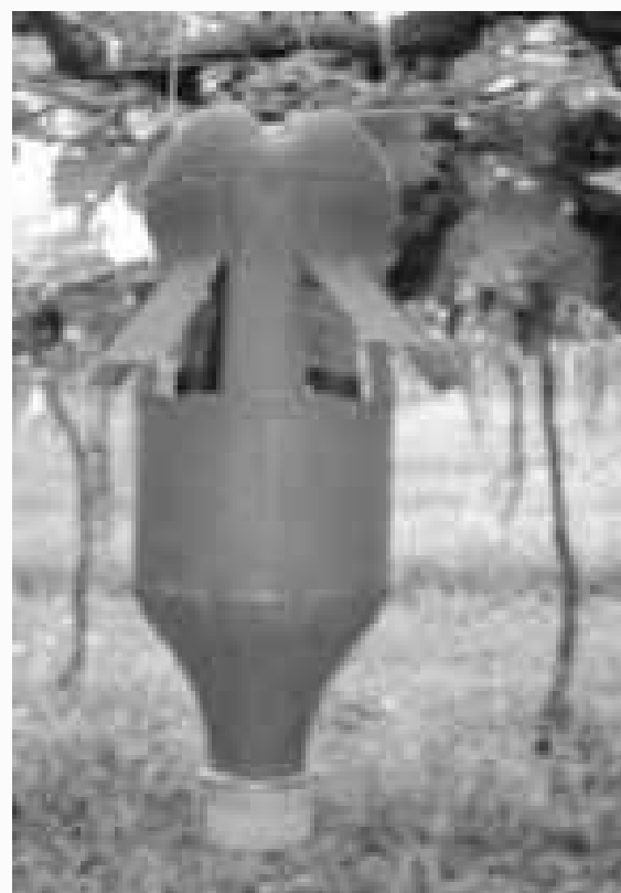
Figura 3. Modelo experimental da armadilha Pet-milho utilizado nos testes de monitoramento do gorgulho-do-milho em parreirais
