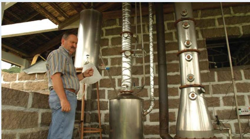
Modelo pioneiro de microdestilador usado para cursos e demonstrações na Estação Experimental de Urussanga
