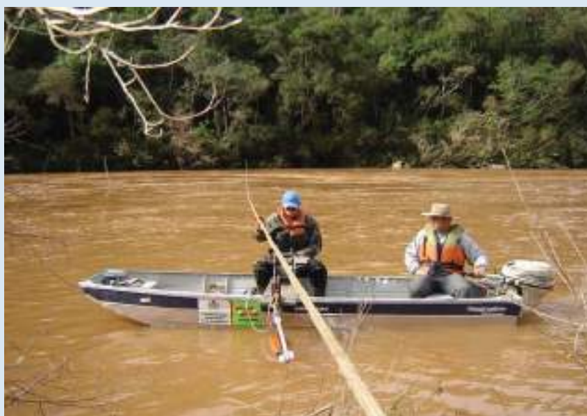
Técnicos da Epagri/Ciram registrando vazão de rio com aparelho de medição de corrente
