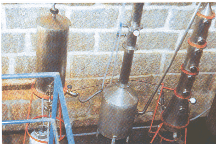
Equipamento de microdestilação artesanal da Epagri / Estação Experimental de Urussanga permite duplo aproveitamento: aguardente e álcool combustível
