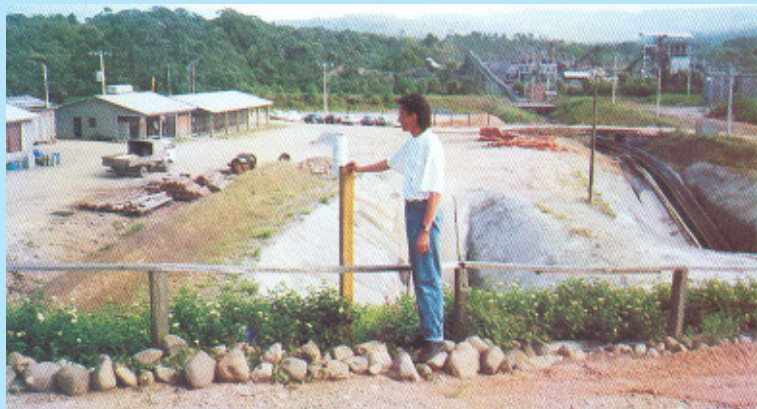
Técnico fazendo coleta de dados sobre precipitação pluviométrica. Aos fundos, entrada da mina e indústria/beneficiamento de carvão
