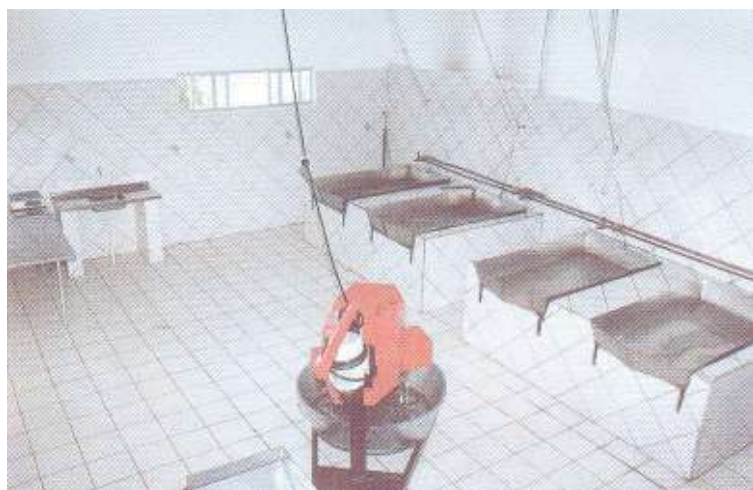
Unidade de processamento de cana-de-açúcar pode elaborar 250kg de açúcar mascavo e 80kg de melado ao dia
